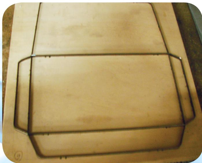
*Cortante para um envelope grande (saco). As lâminas estão montadas numa base de madeira. As do exterior cortam, mas as do interior apenas vincam.*
