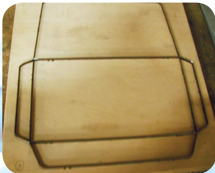
*Le coupant pour une grande enveloppe (sac). Les lames sont montées sur un socle en bois. Les lames du dehors coupent, celles du intérieur ne font que des plis.*
