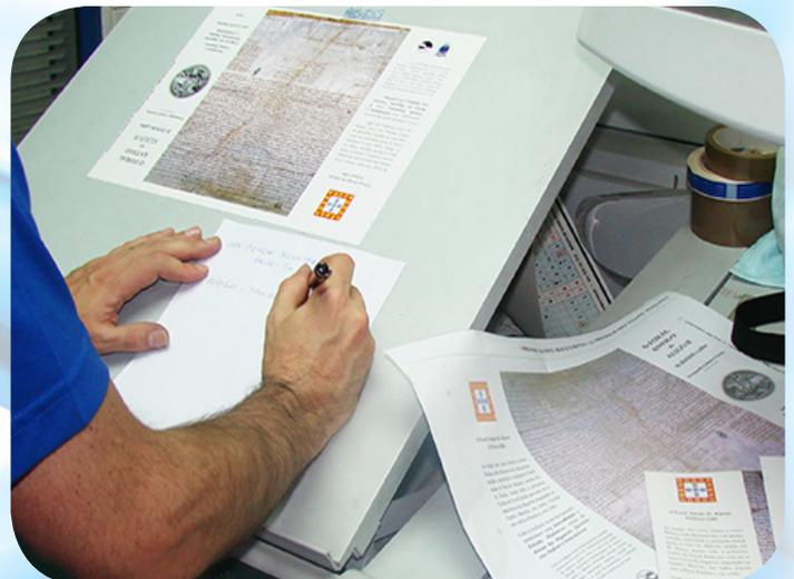
*Antes de imprimir, color y calidad de impresión se controlan en un panel de control. A cada nuevo ajuste se imprimen nuevas copias y se examinan para ver el resultado. Incluso cuando la impresión está en curso, se retira una copia periódicamente para inspección.*
